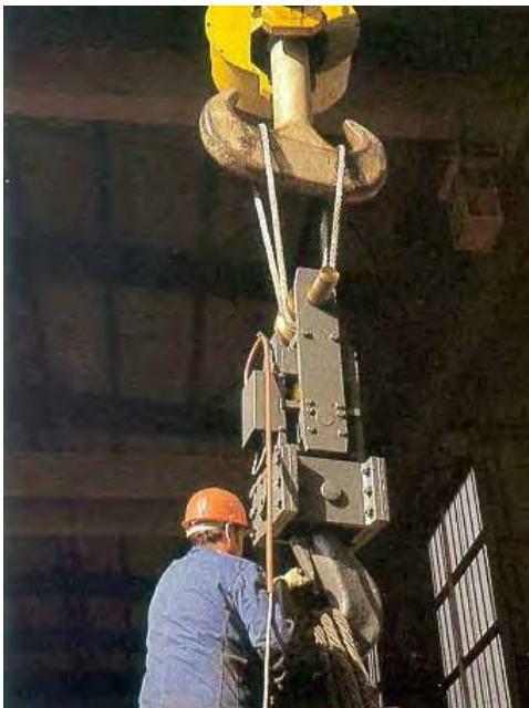
25-тонный весовой блок крюка коммерческих крановых весов с передвижным измерительным блоком, для взвешивания корабельных частей
