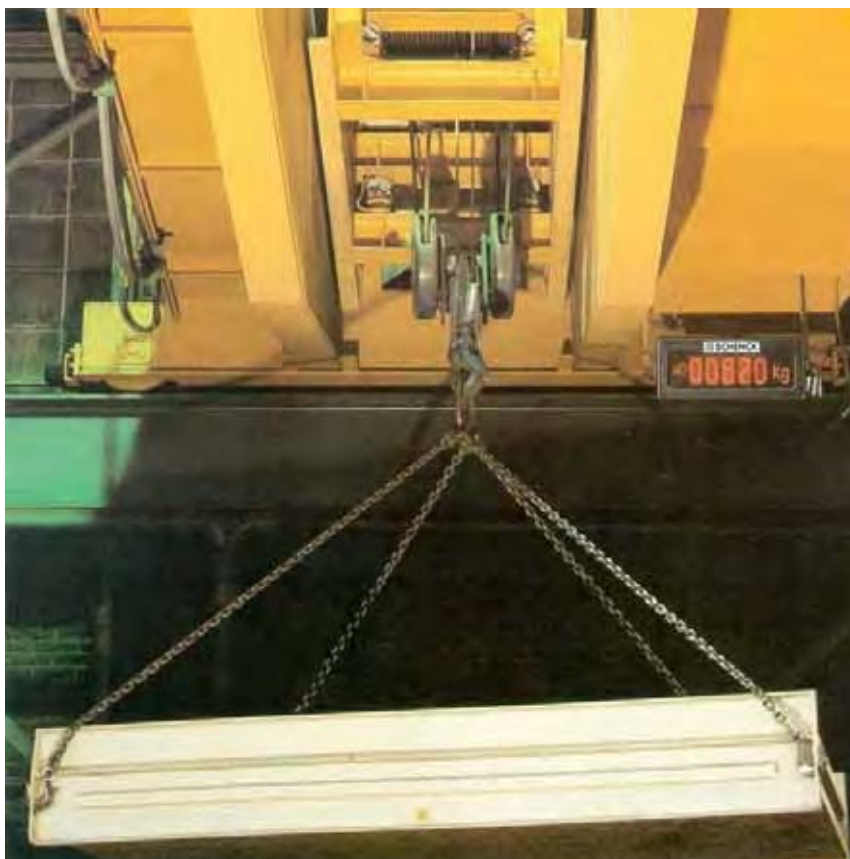
10-тонный мостовой кран с коммерческими крановыми весами в цеху отгрузки
