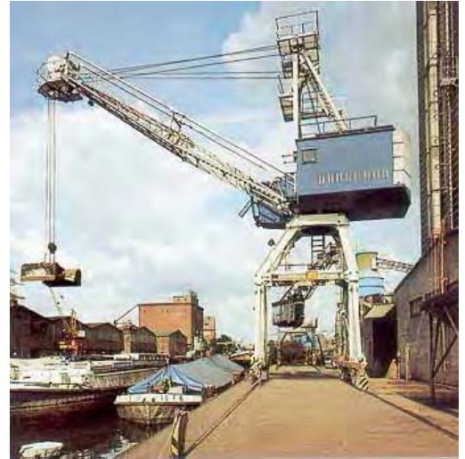
12-тонный консольный кран с коммерческими весами, установленными в жесткой консоли
